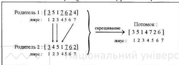
Рис. 3.127. Схрещування зі збереженням порядку в генетичному алгоритмі програми Evolver .
