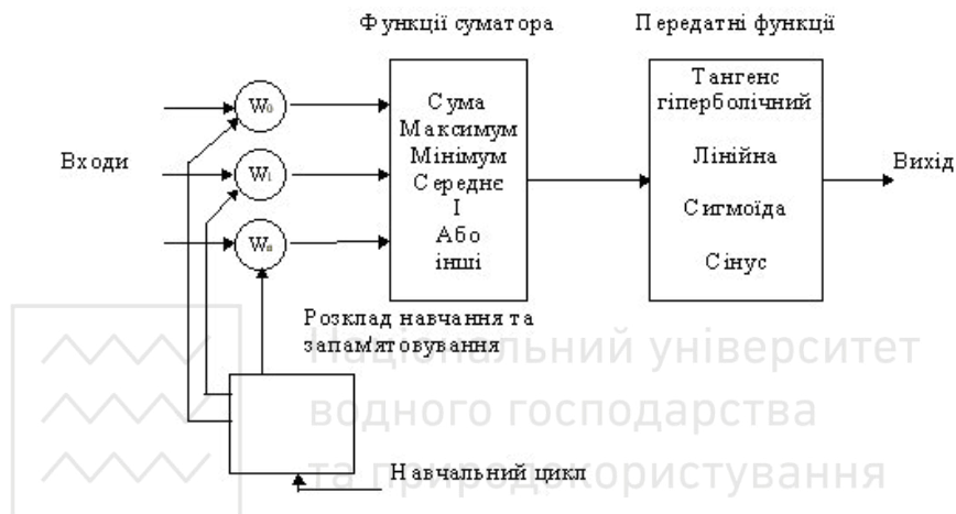
Рис. 2.6. Схема спрощеного штучного нейрона.
