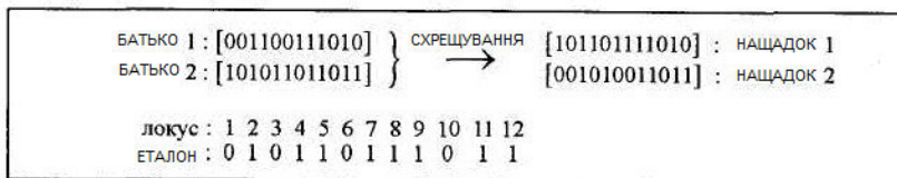
Рис. 3.32. Приклад рівномірного схрещування.
